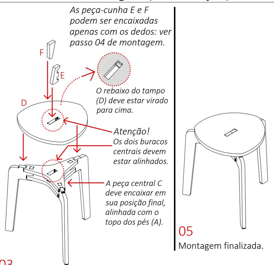
As peça-cunha E e F podem ser encaixadas apenas com os dedos: ver passo 04 de montagem.
